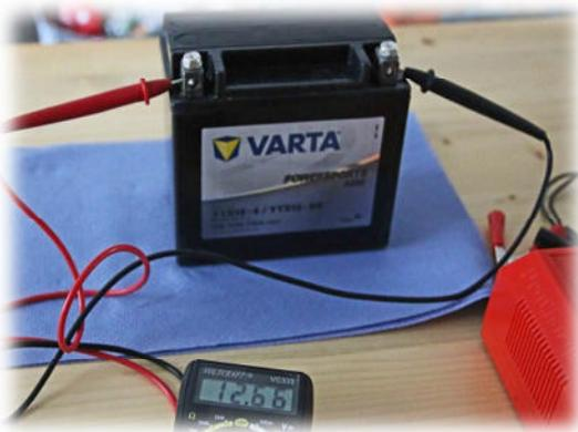
Mit einem Multimeter misst man nun die Spannung um festzustellen, ob die Batterie gleich verwendet werden kann. Werden mehr als 12,7 Volt ermittelt, kann die Batterie sofort eingesetzt werden. Liegt die Spannung darunter, so heißt es vorher aufladen.
