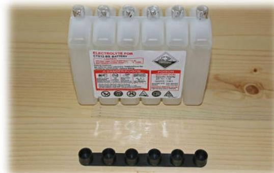
Vorbereitetes Batteriegehäuse am besten auf säurefeste Unterlage stellen oder alternativ auf Putzpapier, Karton oder ähnlich saugender Unterlage platzieren.
